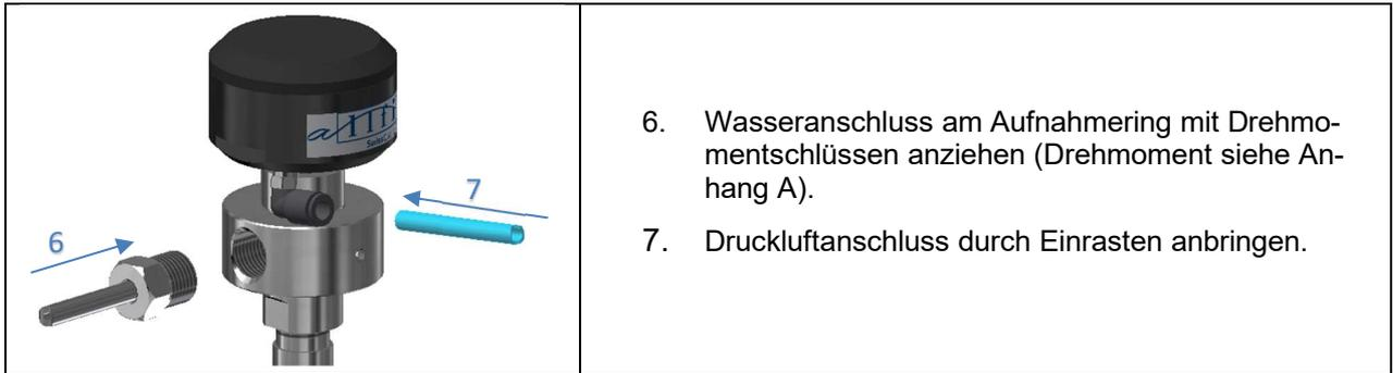
6. Wasseranschluss am Aufnahmering mit Drehmomentschlüssen anziehen (Drehmoment siehe Anhang A).
