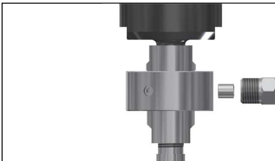
1. Druckschraube aus Aufnahme ring schrauben.
