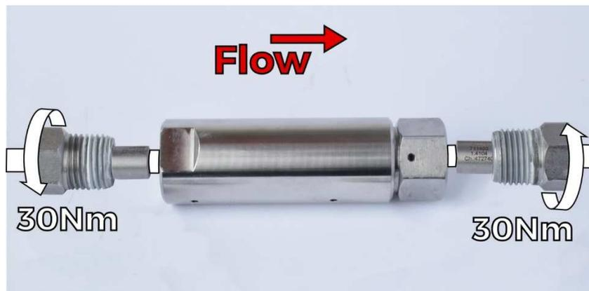
Zum Anziehen Aufsteck-Maulschlüssel SW 17 (000339) bzw. 5/8" (000521) verwenden.
