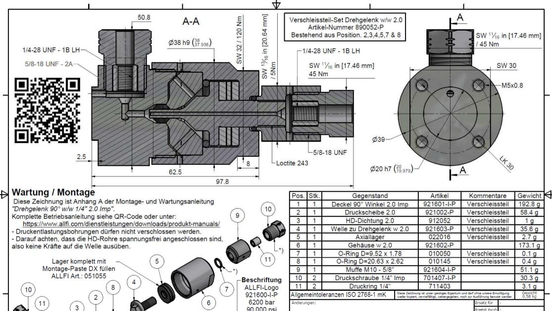
Sezeichnet Massstab Drehgelenk 90° w/w 1/4" 2.0 Imp reigabe 29.06.2021 2:1 Indexfreigabe Max. 6200 bar / 90,000 psi Components
