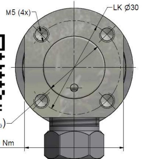
Verschleisstück-Set Drehgelenk 2.0 4150 bar
