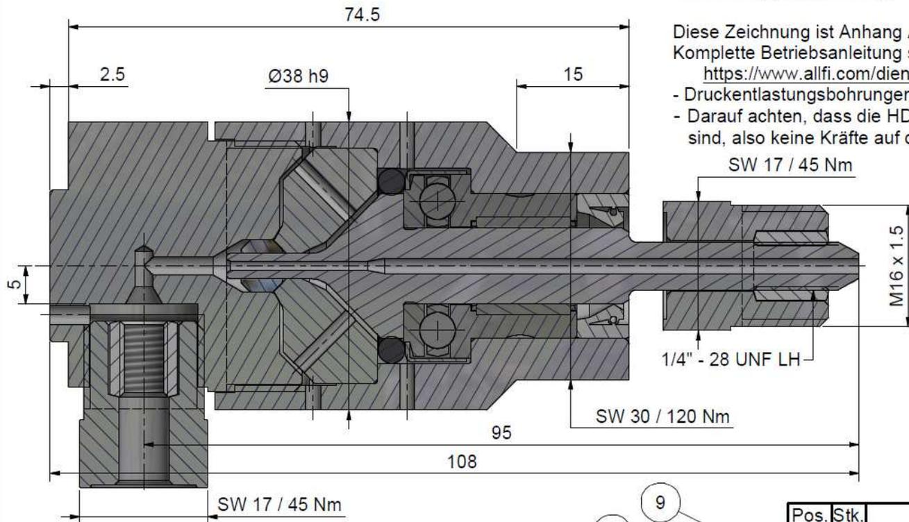
Diese Zeichnung ist Anhang A der Montage- und Wartungsanleitung "Drehgelenk 2.0".
