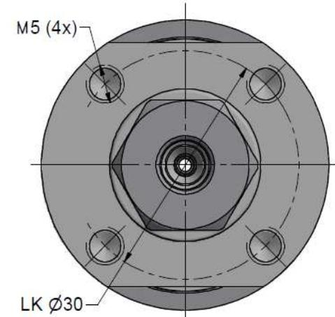
Verschleisstück-Set Drehgelenk 2.0 4150 bar
